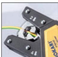
2. Dénuder le câble, l'ajustement se fait automatiquement à la section du câble.
