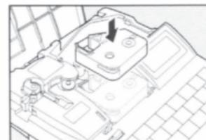
**5** Installer le guide pour profils et gaines
