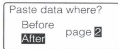
Appuyer [◀] ou [▶] pour sélectionner la page, puis appuyer [▲] ou [▼] pour sélectionner l'endroit (avant ou après la page) où le texte doit être inséré.
