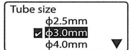
Un sigle  apparaît pour sélectionner le diamètre du support à imprimer.
