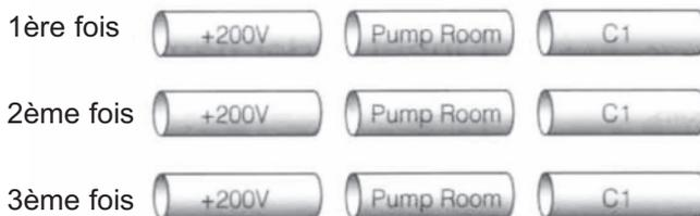
Si "2" est sélectionné pour l'impression et "Start page : 2" (début page 2) et "End page : 3" (fin page 3), les segments de tube sont imprimés tel qu'indiqué ci-dessous.
