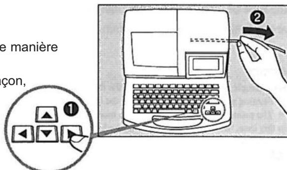
Si le ruban cassette n'a pas pu être retiré au point 3 et le ruban étiquette au point 4, ouvrir le couvercle et vérifier si ils peuvent être retirés.
