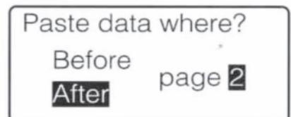
Appuyer [◀] ou [▶] pour sélectionner la page, puis appuyer [▲] ou [▼] pour sélectionner l'endroit (avant ou après la page) où le texte doit être inséré.
