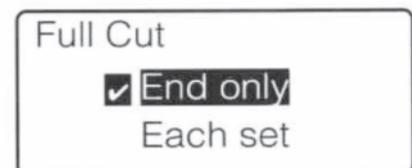
Initialement, "End only" est sélectionné. Cette fonction permet de couper le tube à la fin de l'impression de tous les segments.
