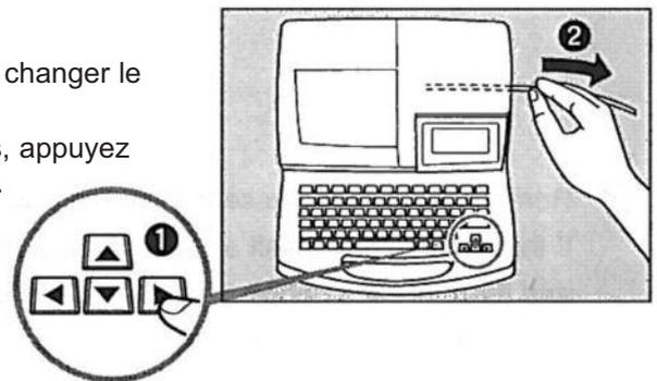
Si la cassette ruban ou le ruban étiquette ne peuvent pas être retirés comme expliqué dans les points 4 et 5, ouvrir le couvercle et vérifier si ils peuvent être retirés. Si c'est le cas, les retirer et refermer le couvercle.
